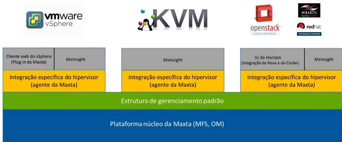
Figura 1: arquitetura independente de hipervisor da MxSP
